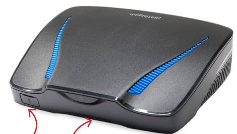
USB Port Vorderseite: Stand-by Knopf und LED
